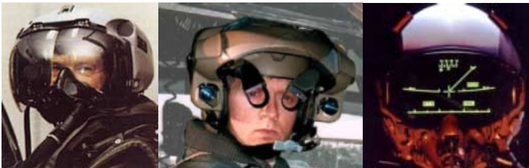
Lentäjän visiiriin heijastuu heijastuu maali ja tilannetietoja ja aseet kohdistuva katseen mukaan (Kuvat DaimlerChrysler AerospaceAG, TELDIX GMBH ja Ericson Saab Avionics AB)
