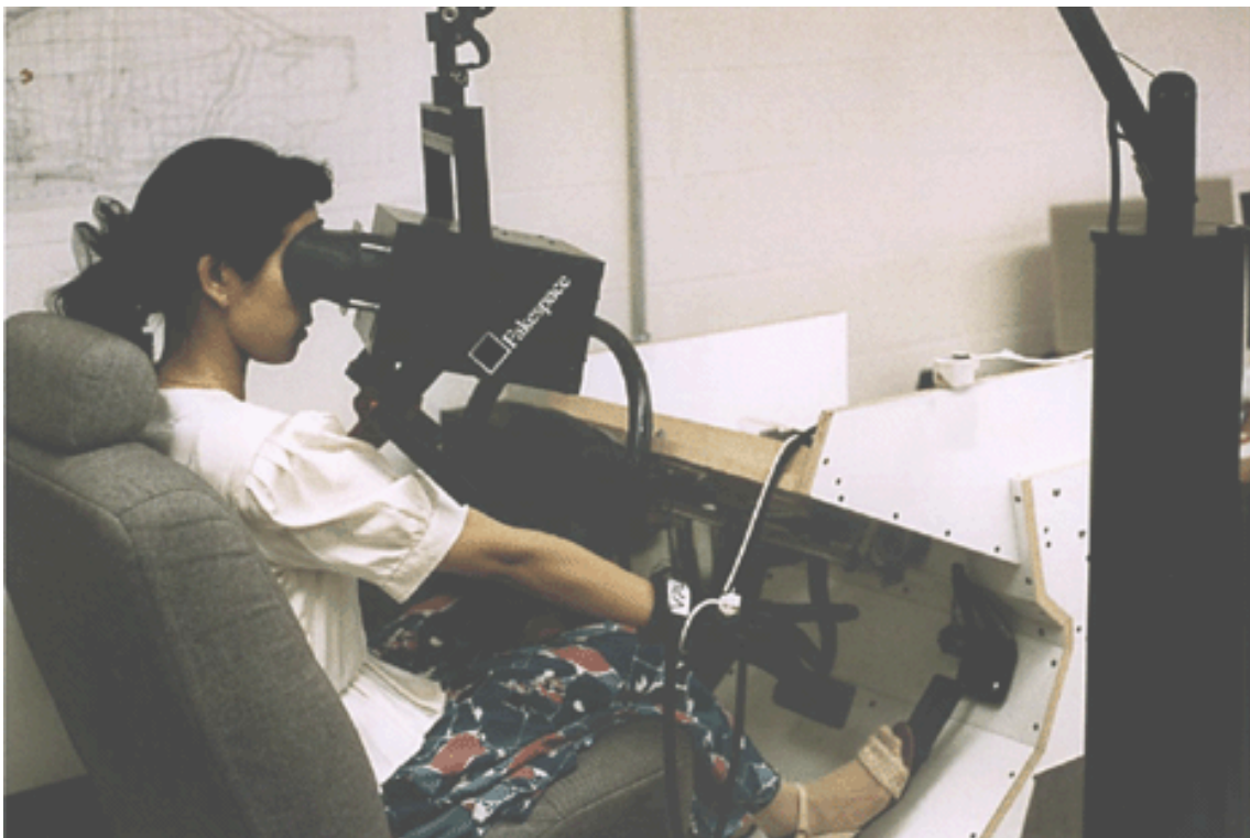
Kuva 8. Koehenkilö testaamassa auton ohjaamon käytettävyyttä fyysisen mallin ja virtuaalitekniikoilla tuotetun ympäristön yhdistelmällä.
