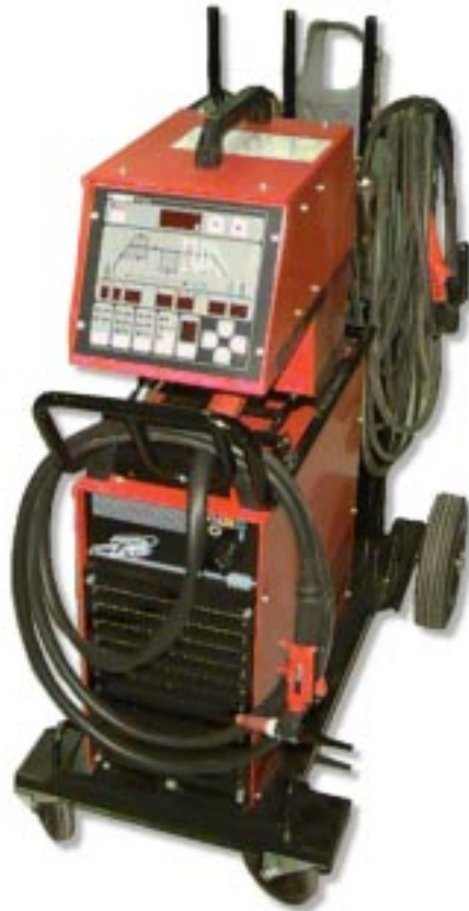
Kuva 12. Kemppi Protig 400 hitsauslaite, joka on varustettu uudella, ”digitaalisella” käyttöliittymällä
